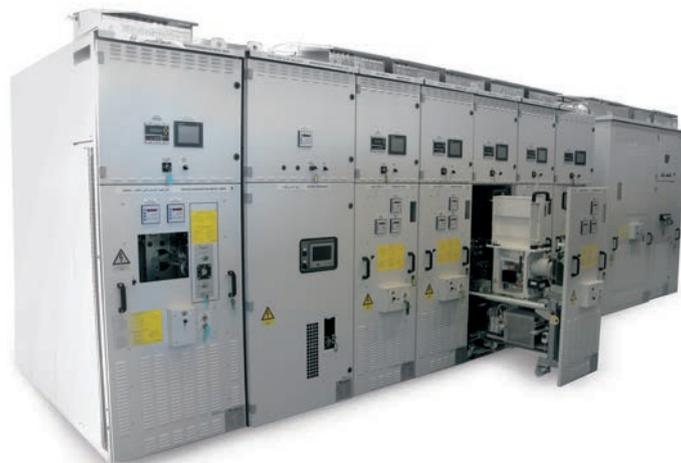
I QUADRI BLINDATI MCS in esecuzione estraibile sono disponibili con tenuta all'arco interno (classe IAC = AFLRI) MCS, e sono progettati, costruiti e testati secondo la normativa IEC 62271- 200 con  $I_{ss} = 80kA$  per 250ms con tensione di targa da 900 a 1800 Vcc e  $I_{ss} = 53kA$  per 250 ms con tensione di targa de 3600 Vcc.
